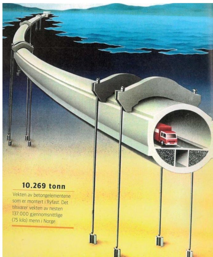
Eitt av fleire konsept: Tverrsnitt av røyrbru.
